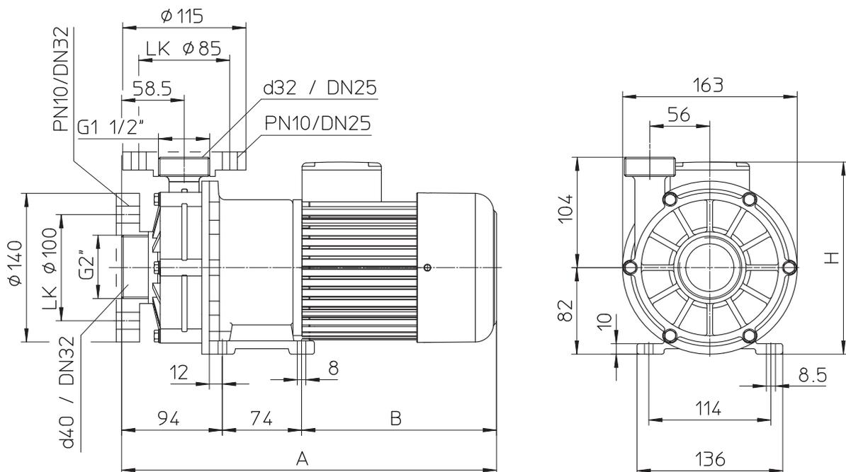
Klemmenkastenstellung: Standard oben (falls rechts oder links gewünscht, bitte bei Bestellung angeben)
